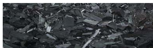
Рис. 2 – Древесный уголь, полученный в опытах по пиролизу березовой щепы.
