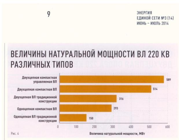
Рис. 12. Величины натуральной мощности ВЛ 220 кВ различных типов
